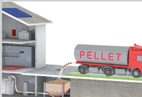
Példa pellet feltöltésre tartályos autóból
