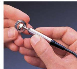
Mikroszonda a kisméretű darabkhoz, nehezen hozzáférhető helyekhez
