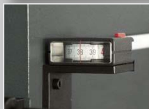
Maßbandanzeige für Y-Achse
