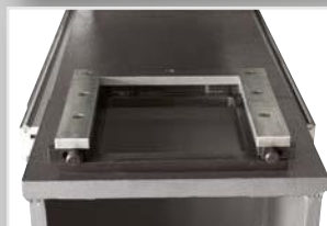
Matrizenaufnahme, Werkzeugwechsel auch bei eingelegter Schaltschranktür
