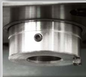
Stabile Kolbenstange (Ø 55 mm) mit Werkzeugverdrehssicherung
