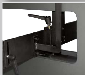
Anschlagsystem in Y-Richtung verfahrbar, 2 Führungswellen im Presskörper.
