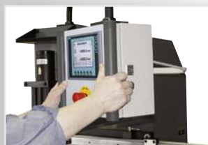
Schwenkbares Bedienpult mit Zweihandbedienung
