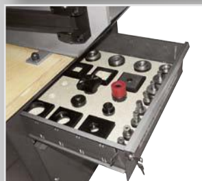
Werkzeugschublade mit Facheinteilung
