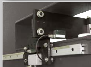
Wegmessung der X- und Y-Verfahrwege
