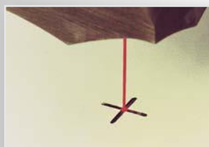
Laserpointer zur optischen Anzeige der Werkzeugmitte
