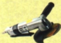
Sarokcsiszológép 125 mm fordulát 11000 Levegőigény 320 liter/perc
